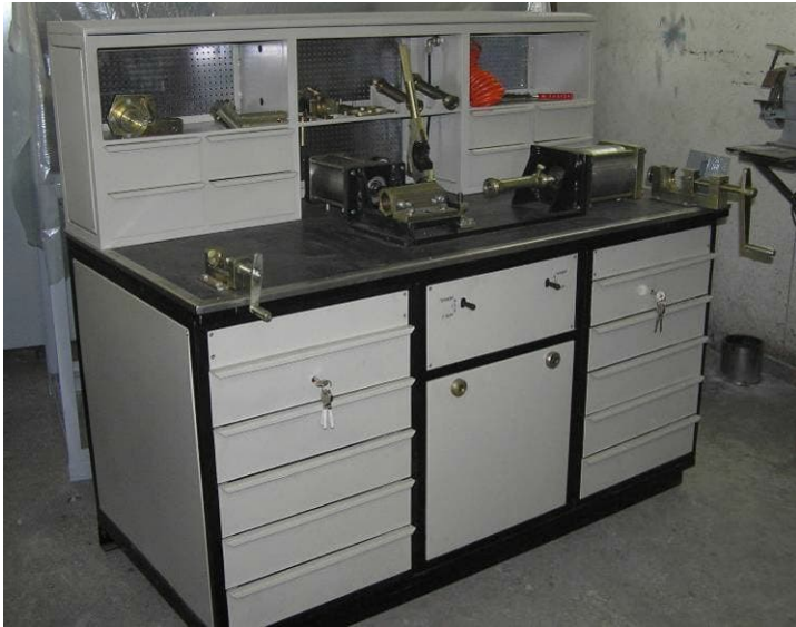
MP-018 (пневмопривод коробки ЭКК, рукав тормозной системы P32, P34, P21, P23: сборка, разборка)
